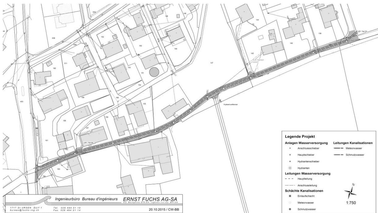
Auf der gesamten Länge soll die Mischwasserkanalisation ersetzt und dem Trennsystem zugeführt werden. Die heutige Kanalisation, die das Oberflächenwasser aufnimmt und sich gemäss Kanalfernsehaufnahmen in einem schlechten Zustand befindet, entspricht nicht mehr den technischen Vorschriften. Inskünftig wird das Strassen- und Dachwasser in einer neuen Meteorleitung, separiert von der Schmutzwasserleitung gemäss Trennsystem, abgeführt.
